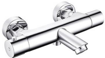
Le mitigeur thermostatique bain-douche GARANCE 3 dispose de deux poignées distinctes : l'une règle la température avec sécurité anti-brûlure à 38°C, l'autre contrôle le débit d'eau.
